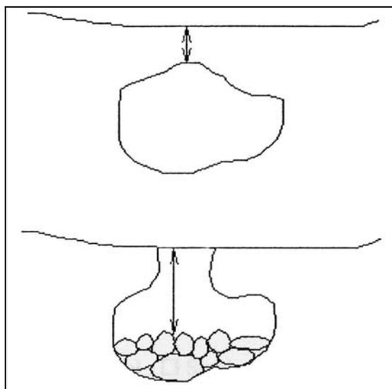
**Figure 10 - Schéma de principe du phénomène d'effondrement**
