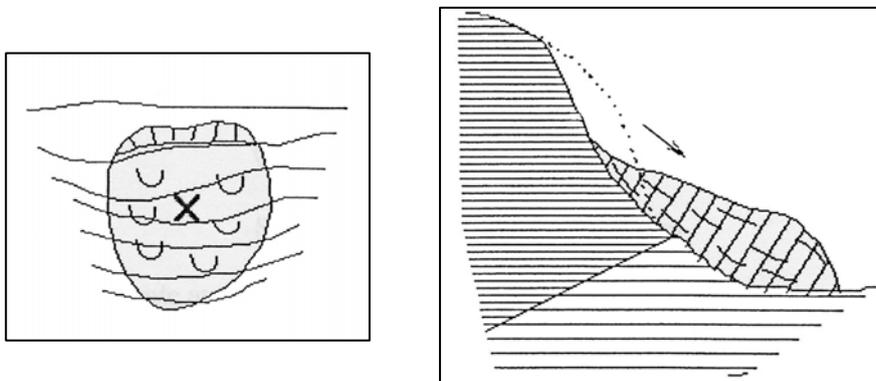
**Figure 12 - Schémas de principe du phénomène de glissement (vues plan et coupe)**
